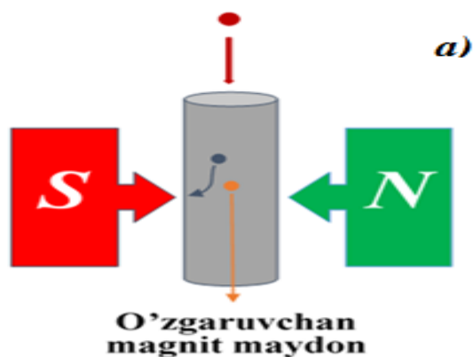
5 – rasm. Kukunlarni o'zgaruvchan magnet maydonida tozalash sxemasi.
