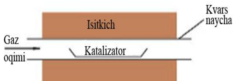
2-rasm. Fulleren va kukunlarni bug‘dan kimyoviy cho‘ktirish yo‘li bilan oluvchi qurilma sxemasi
